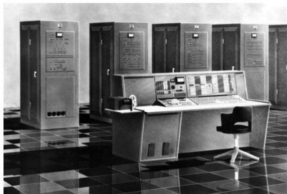
Ламповая ЭВМ М-100 - самая быстрая ЭВМ в мире того времени (сто тысяч операций в секунду).
